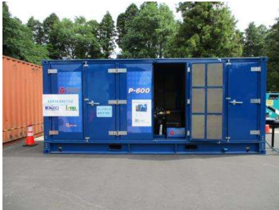
アースシャトル工法機器（マッドポンプ：送泥ポンプ） ※最大吐出量：2.1m 3 /分 総重量：13.5 t ベンツのエンジン
