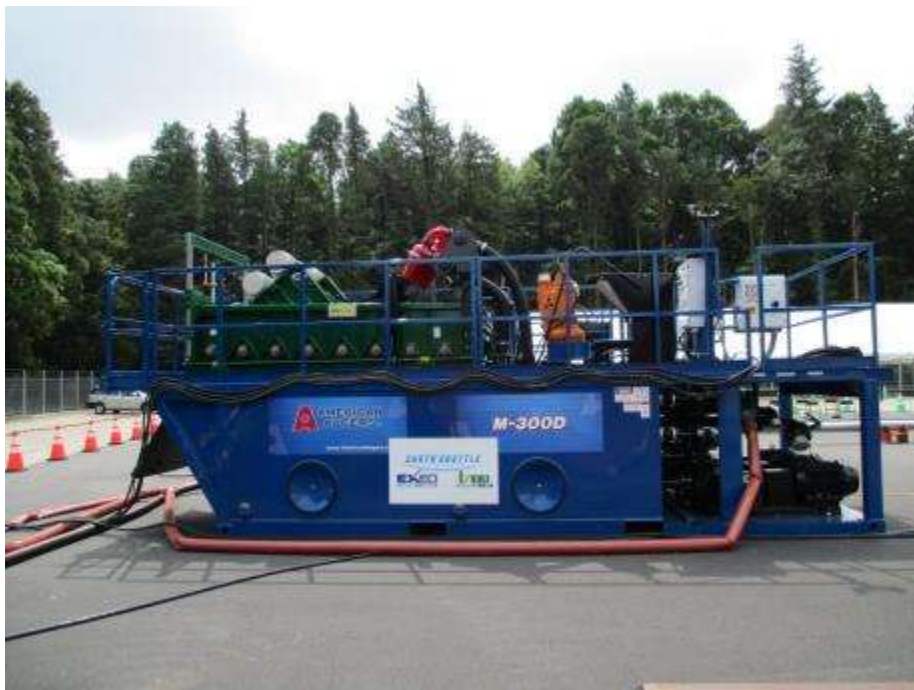
アースシャトル工法機器（マッドポンプ：送泥ポンプ） ※最大吐出量：2.1m 3 /分 総重量：13.5 t ベンツのエンジン
