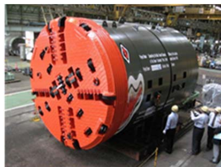
世界最大級、直径4m超の掘進機 同社の高い技術力により、中東にて 500m以上の難工事を成功させた。
